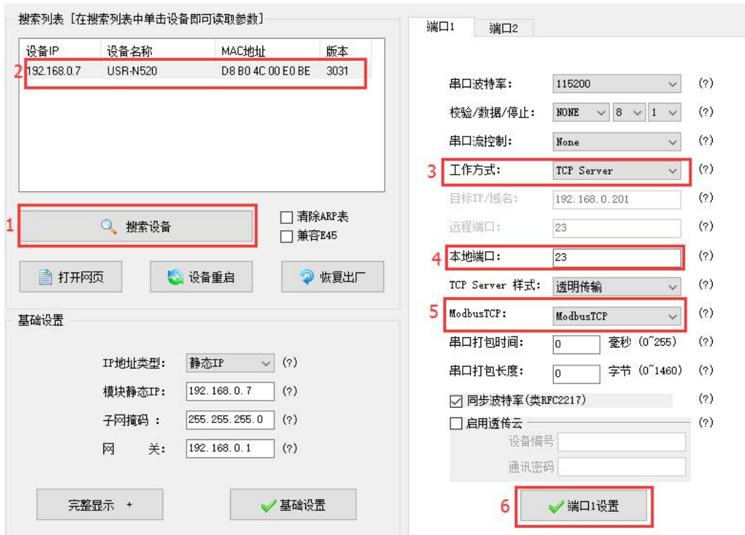
图 40 Modbusrtu 转 Modbus tcp
