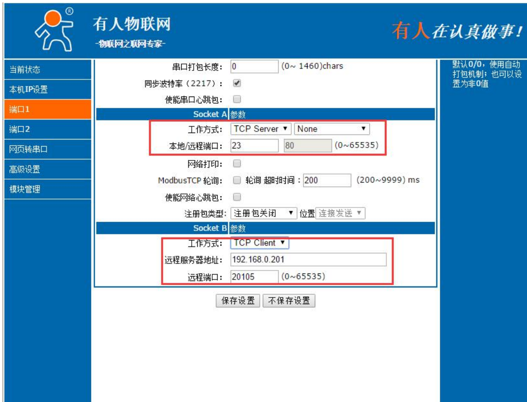
图 6 Socket A/SocketB 设置方法
