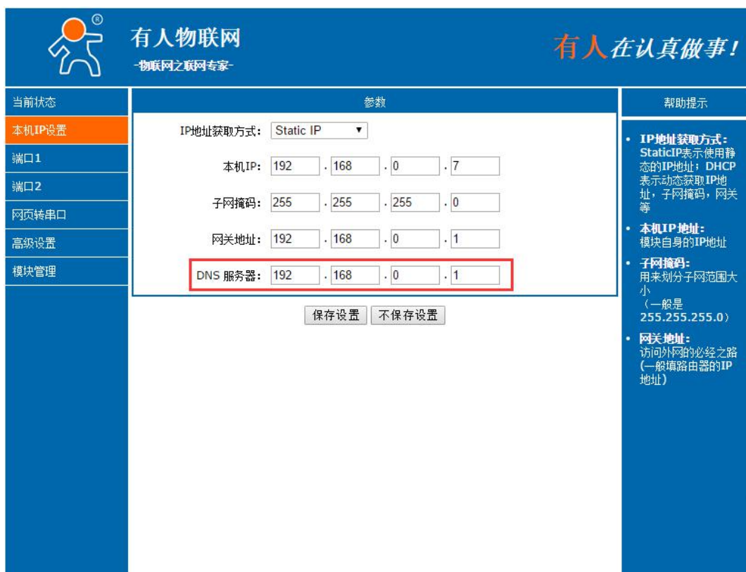
图 3 设置 DNS Serve IP 地址
