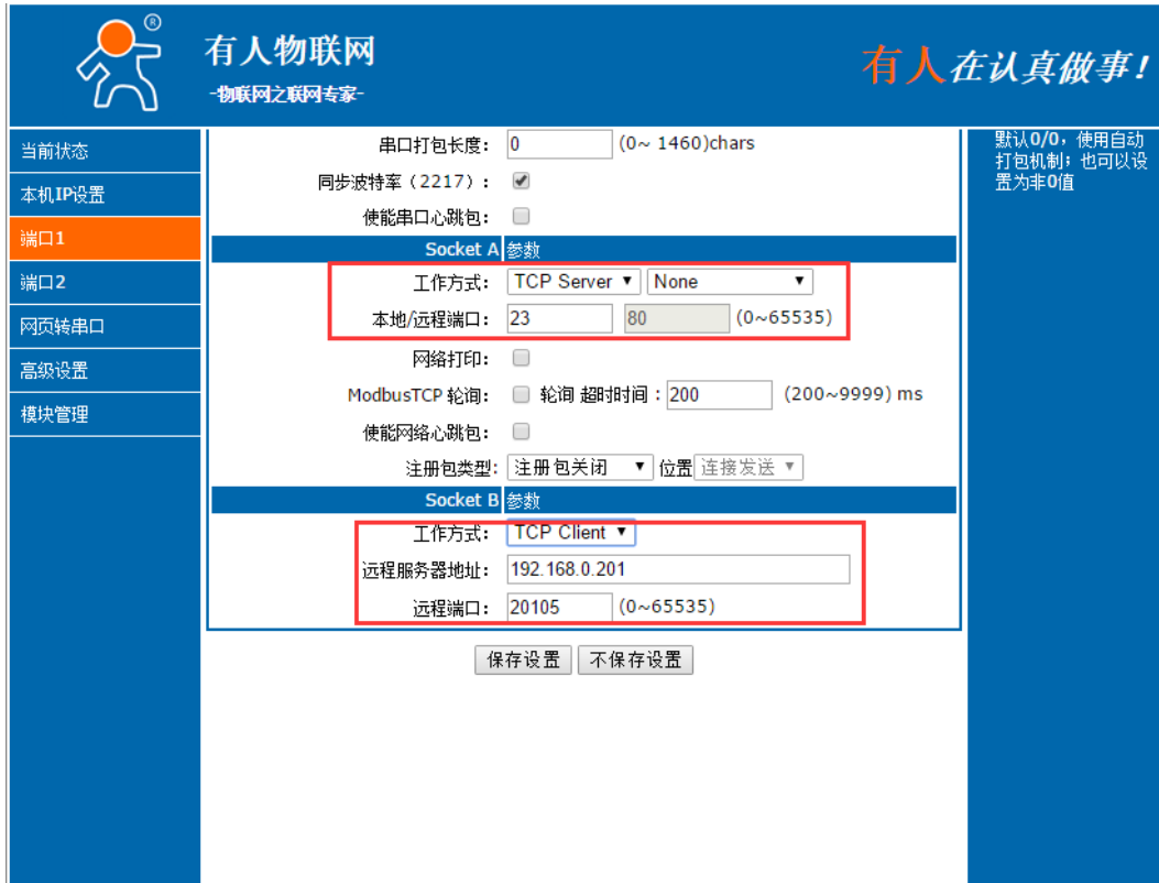
图6 Socket A/SocketB 设置方法
