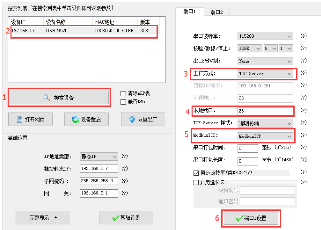
图40 Modbusrtu 转 Modbus tcp
